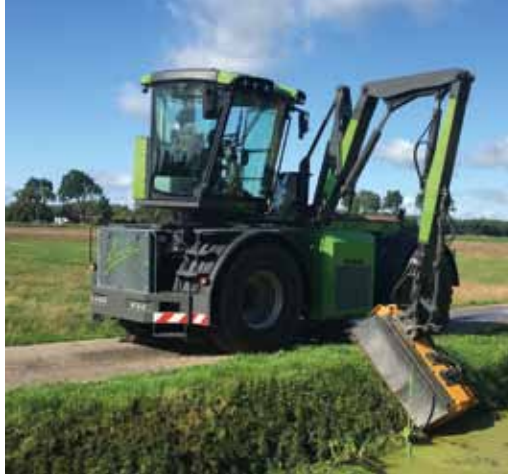
De Exentrac van Hemos heeft twee gieken die beiden onder het voertuig ingeklapt kunnen worden voor onbelemmerd zicht in het verkeer.
