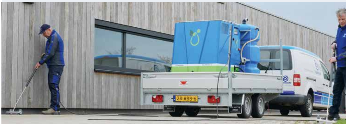
De WeedMaster-eL: een milieuvriendelijke, elektrisch aangedreven onkruidbestrijdingsmachine voor gebruik door twee personen tegelijkertijd
