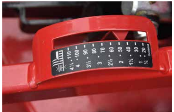
De maaihogte is duidelijk en eenvoudig af te lezen
