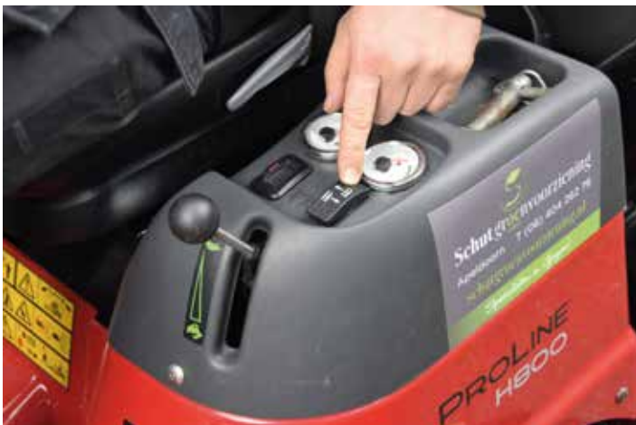
De elektrische instelling van de maaihogte
