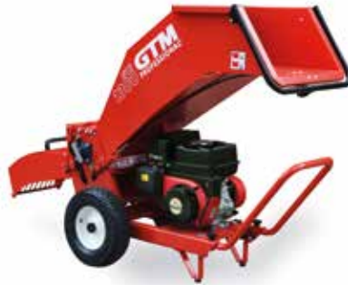
De GTS1300C en de GTS900C kunnen na vrij simpel sleutelwerk de snippers ook boven uitblazen.
