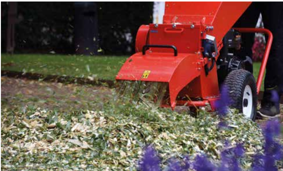
Ook zachter, vezelrijker en vochtiger materiaal kun je versnipperen. De GTS1300C gebruikt hiervoor de onderuitvoer.
