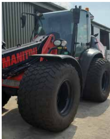
Extra brede banden onder de trekker voor de reductie van bodembelasting.
