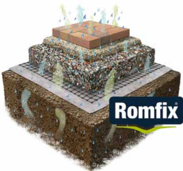
Romfix-opbouw voor draagkrachtige ondergronden
