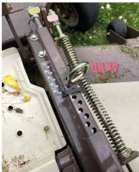
Hoogte-instelling: rechts even de vergrendelpen verzetten
