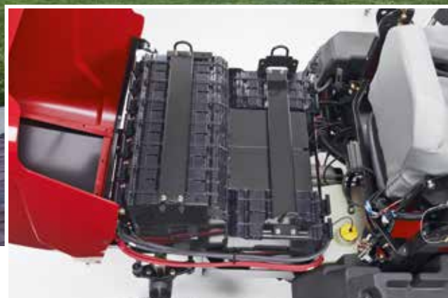
De machine werkt met Toro's Hypercell lithium-ionaccutechnologie.
