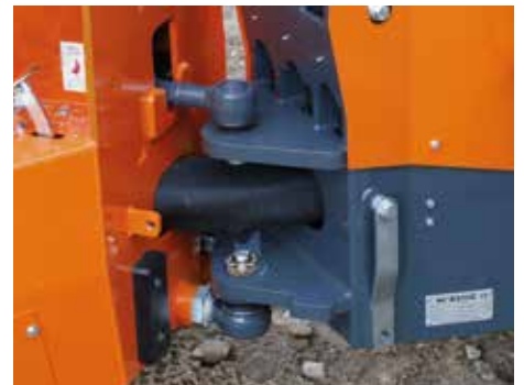
Het aantal hydrauliekslangen door het knikpunt is beperkt.
