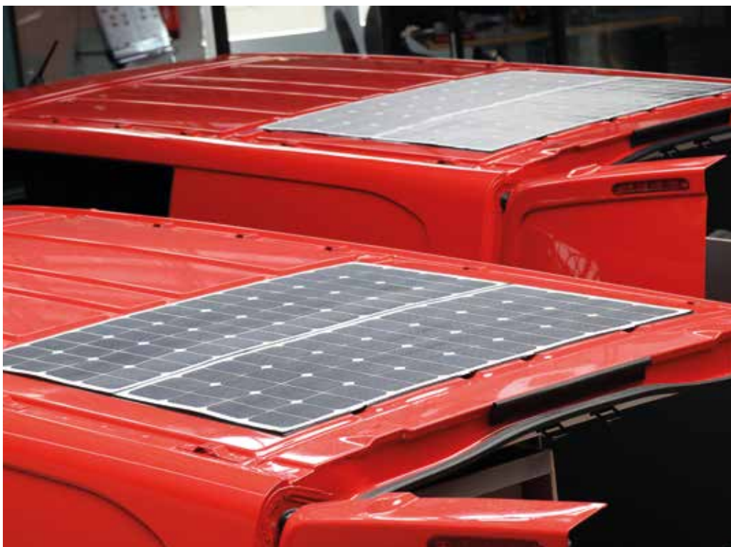
Zonnecellen met een vermogen van zo'n 1.000 wattpiek op de nieuwe werkbussen voorzien de Zeliox van stroom.
