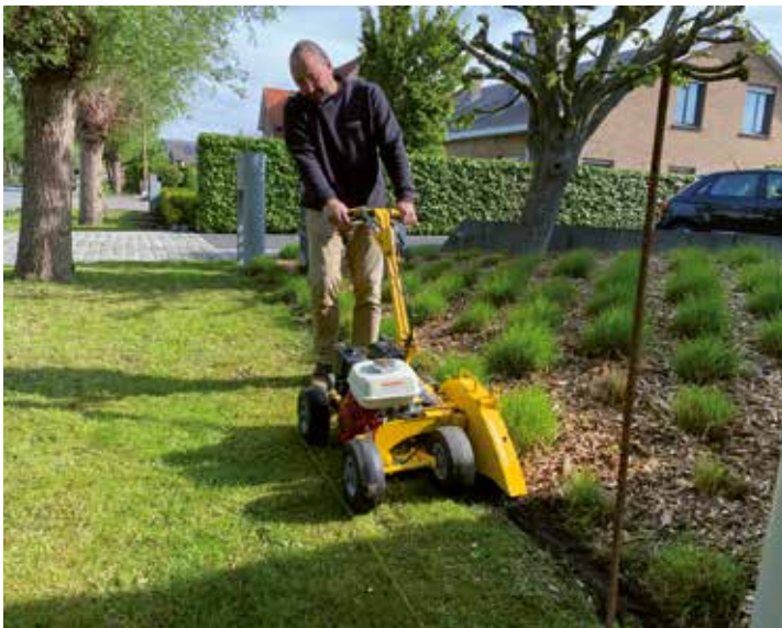
Het is ook mogelijk om een duimbrede gleuf te frezen. Daarvoor gebruik je een eenvoudig mes.
