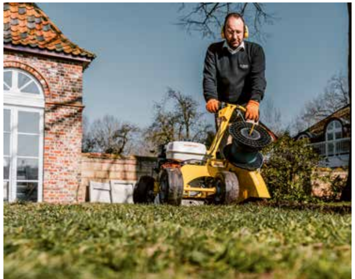
Perimeterdraad leggen in een gazon met de Jo Beau 650+ en bijbehorende kit
