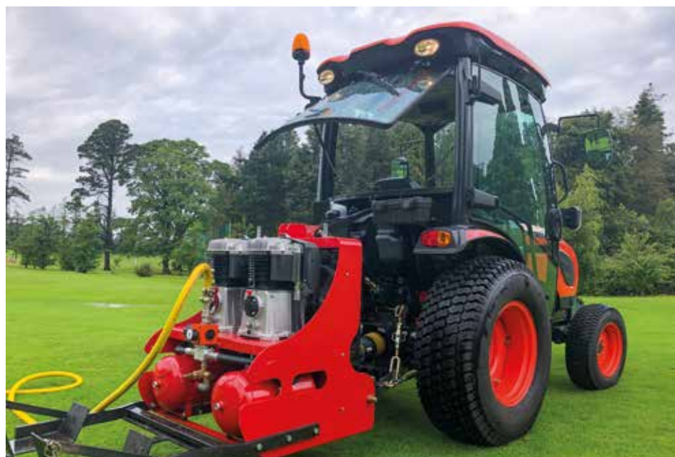
De Oxyslot van Redexim. De bijbehorende compressor werkt op de aftakas.
