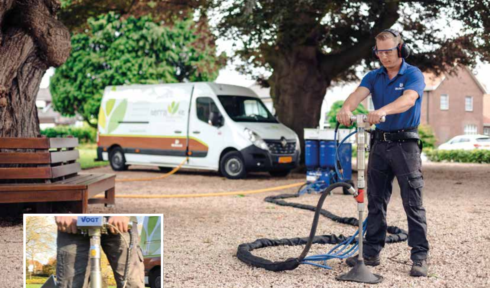
De professionele Vogt Geo Injector Pro heeft een verrijdbare unit voor vulstoffen.
