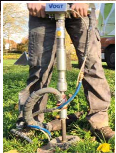
De professionele Vogt Geo Injector Pro heeft een verrijdbare unit voor vulstoffen.
