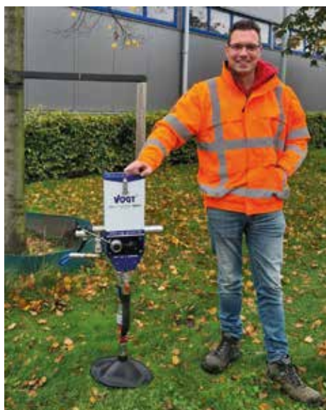
De lichte Vogt Geo Injector Mini, met een reservoir voor onder andere substraat, is bruikbaar voor hoveniers.
