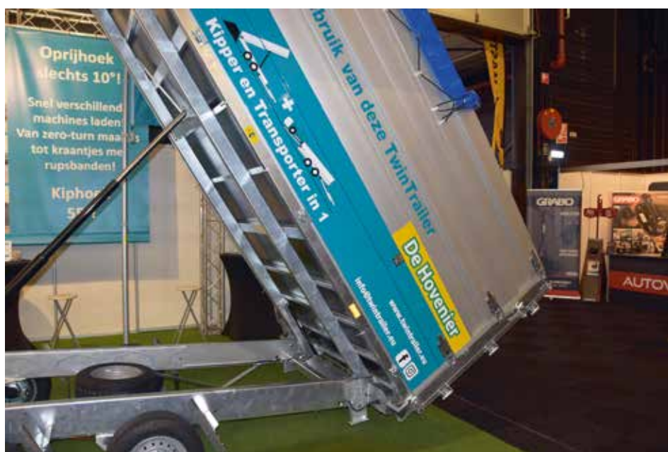
De autonome TwinTrailer laat zich elektrohydraulisch kiepen en je kunt er rollend materieel mee transporteren.
